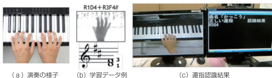
図7. 連続距離画像の分析によるピアノ演奏時の運指認識（デモ動画）
