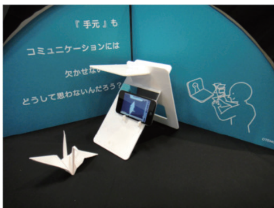
図1：簡易卓上型遠隔作業支援システム「OTEMOTO」
