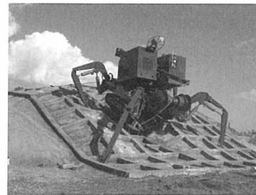
図8 模擬法面歩行実験
