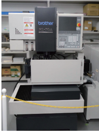
放電加工機 (17号館)
