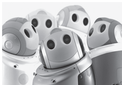
図7 パーソナルロボット PaPeRo。PaPeRo みずからがアクティブに環境を認識・処理することでユーザとの対話の正答率が飛躍的に向上した (藤田さんのご厚意により掲載)
